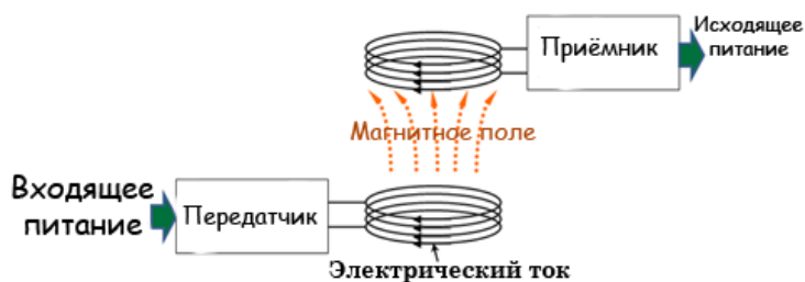
Рис.1 принцип работы беспроводной передачи энергии
